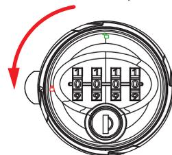
Chiudere la serratura ruotando di 90° fino alla posizione di lucchetto chiuso (rosso).
