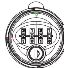
Con la serratura in posizione di aperto, inserire il nuovo codice.
