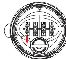
Ruotare i numeri dall'alto verso il basso fino a quando si bloccano; i numeri visualizzati alla fine sono i codici correnti. Estrarre la chiave per aprire.
