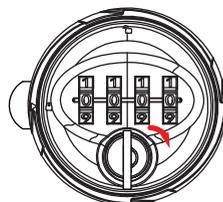
Inserire la chiave master e ruotare di 90° in senso orario.
