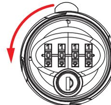
Per chiudere la serratura, è sufficiente ruotare il corpo della serratura di 90 gradi in senso antiorario. Il codice tornerà automaticamente a 0-0-0-0.
